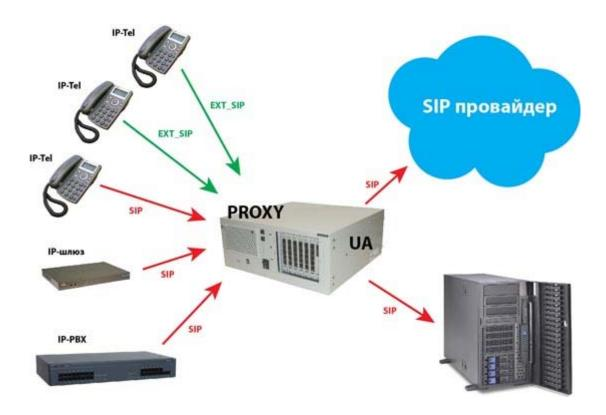
**SIP-абонент (EXT\_SIP)** — полноценный абонент ATC M-200 с полным спектром абонентских услуг и сервисов (СОРМ, тарификация, услуги ДВО и т.п.). Предназначен для подключения IP-телефонов или аналогичного оборудования.
